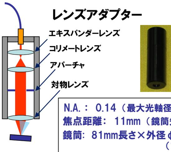
N.A.: 0.14 (最大光軸径 約4mm)
